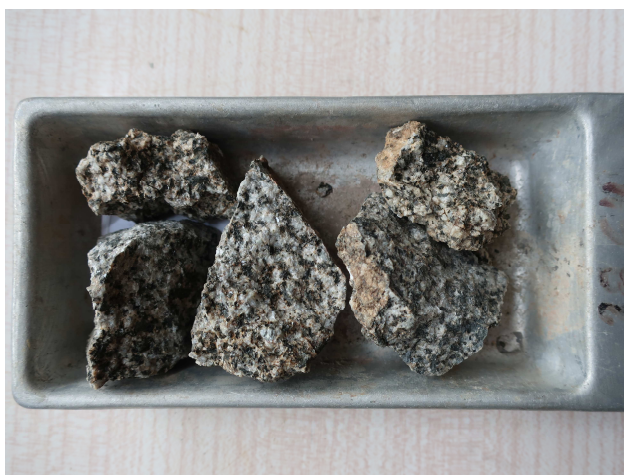
Obr 1: Typické složení a vzhled sázavského granodioritu
